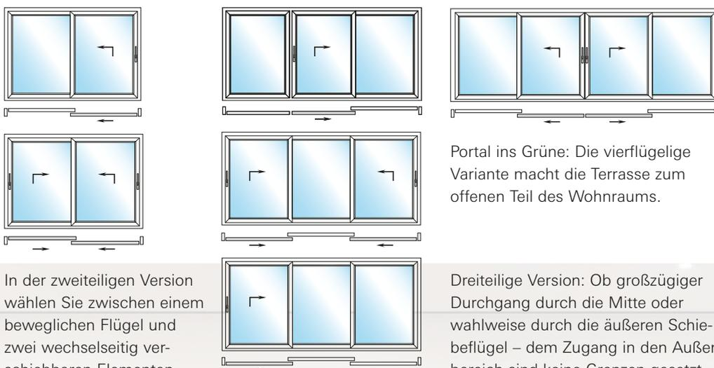
In der zweiteiligen Version wählen Sie zwischen einem beweglichen Flügel und zwei wechselseitig verschiebbaren Elementen.
